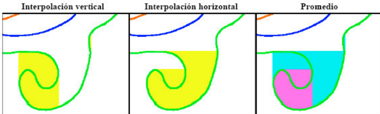
Figura 8.- Errores producidos por una interpolación bilineal.
